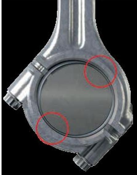
Fig.38 Fallo en cabeza de biela (Fuente MS Motorservice Aftermarket)
