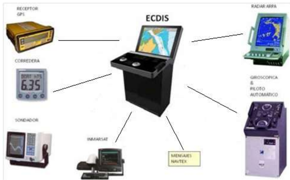
Ilustración 1: Conexión del ECDIS con los equipos del puente Fuente: Cid Álvarez, 2011, p.121
