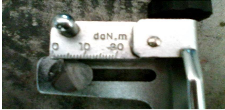
Figura 12: Detalle del ajuste de la llave dinamométrica
