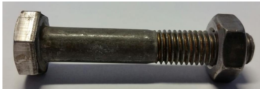
Figura 20: Tornillo Ø 10 – CALIDAD:6.8
