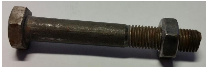
Figura 28: Tornillo Ø 8 – CALIDAD:5.6
