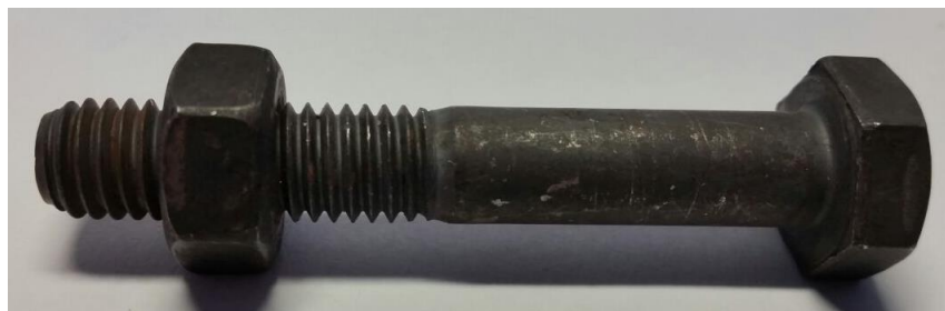
Figura 24: Tornillo Ø 10 – CALIDAD:8.8
