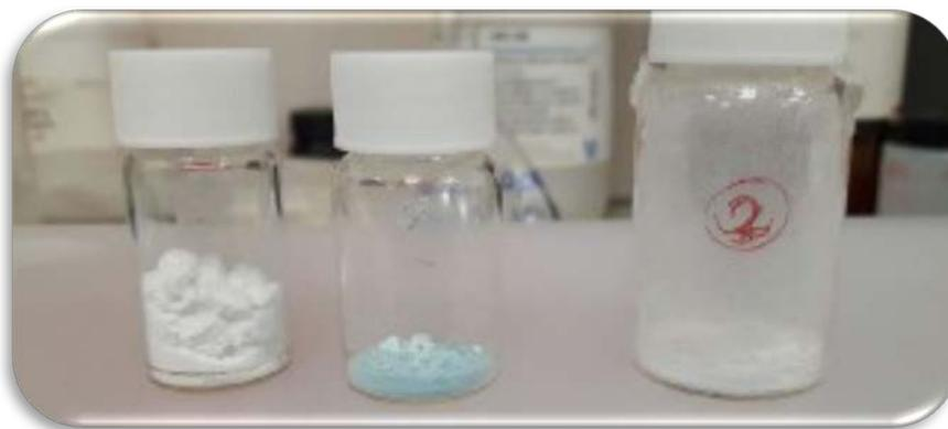
Figura 6. Fotografía que muestra las diferencias en el color de los rellenos. De izquierda a derecha: AM-4 sintetizado en el laboratorio, AM-4 intercambiada con Cu (Cu-AM-4) y Zeolita Y intercambiada con Cu (Cu-Y).
