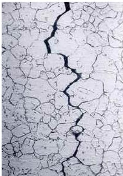
Figura 17. Corrosión bajo tensión intergranular [97].
