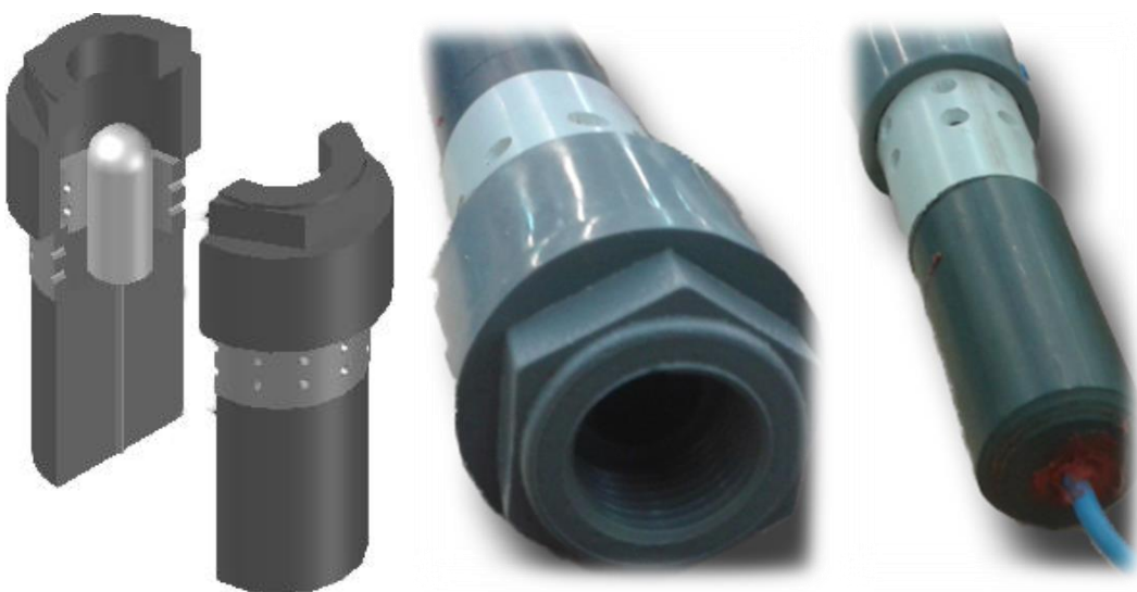
Figura 33: Diseño CAD de la carcasa para el electrodo junto a fotografías de la parte frontal y trasera una vez realizada.
