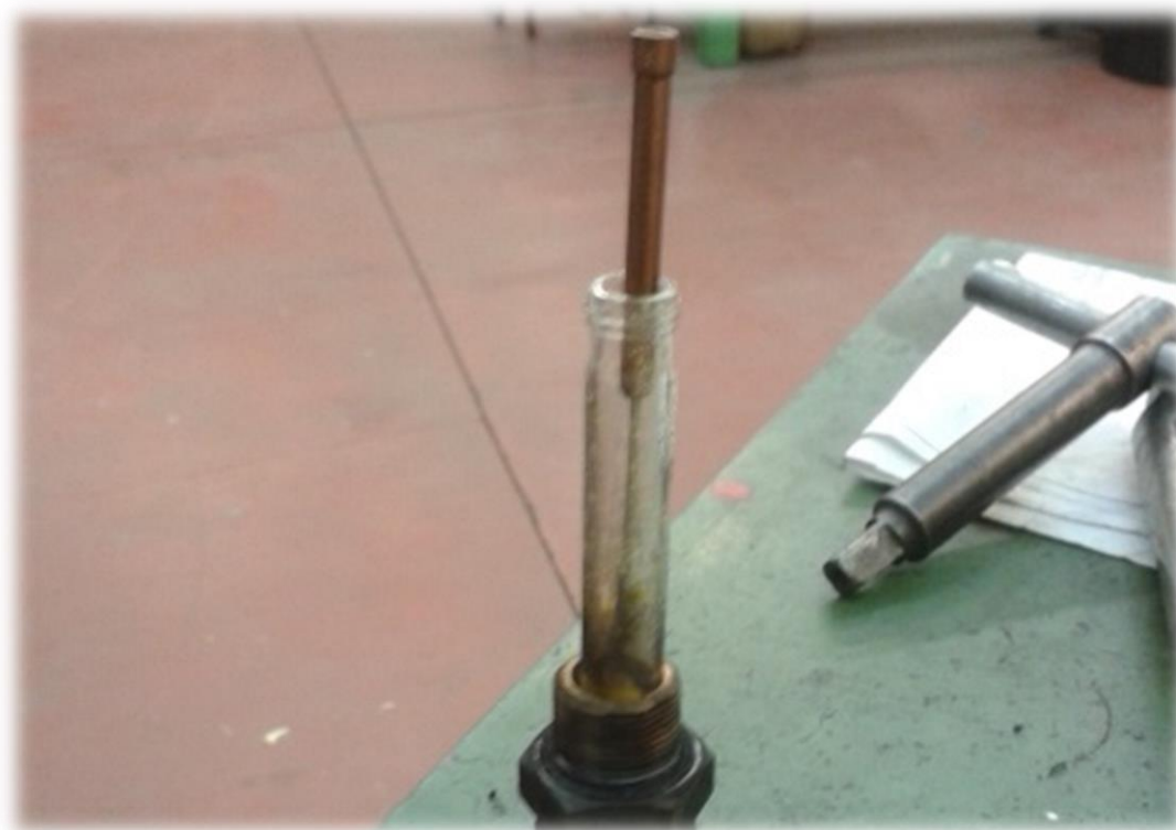
Figura 18. Conductor de plata introducido mientras se enfría el compuesto. Fuente: Propia
