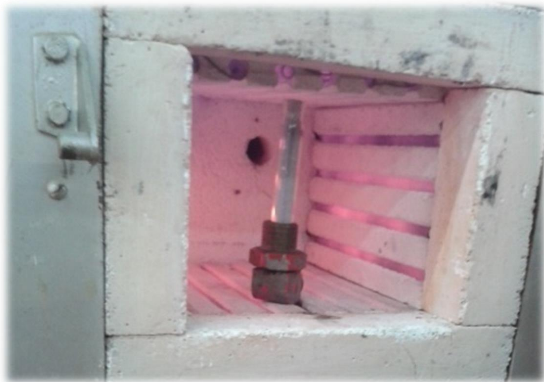
Figura 17. Probeta con el cloruro de plata en el horno de mufla.
