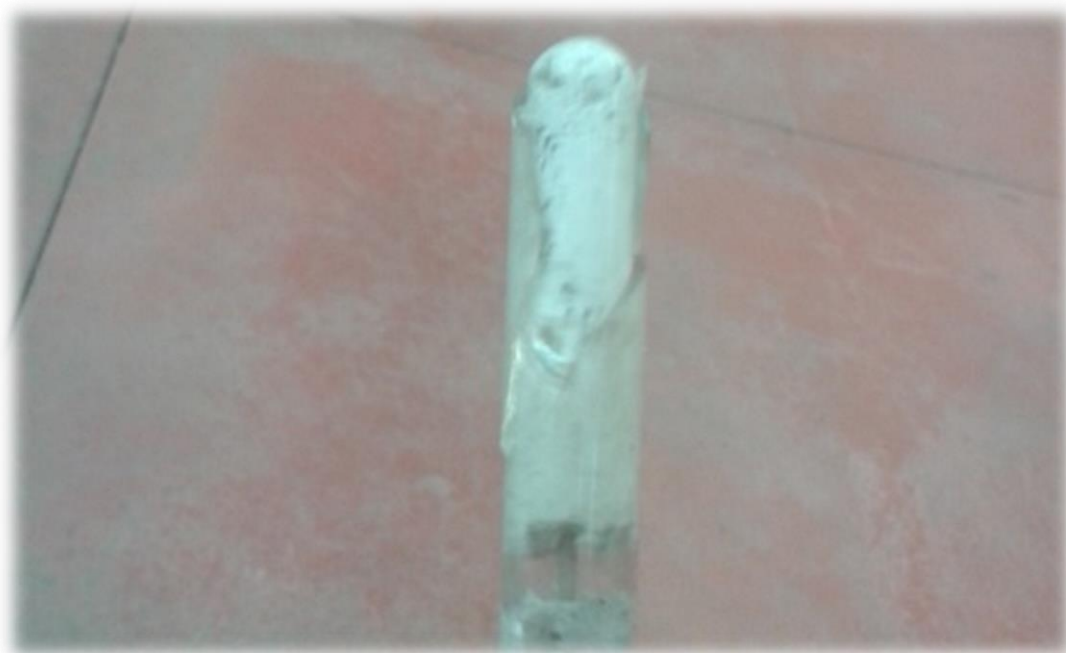
Figura 19: Rotura del cristal para sacar la sonda.
