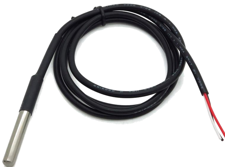
Figura 21: Sonda de temperatura DS18B20 empleada.
