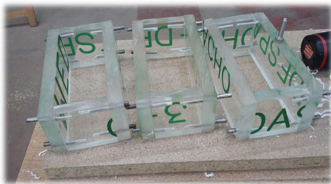
Figura 28: Carcasas realizadas a partir de la lámina de metacrilato.
