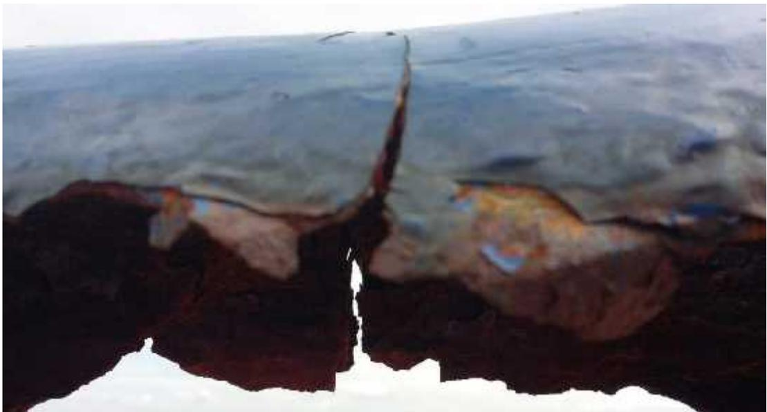
*Figura 16 - Corrosión uniforme
