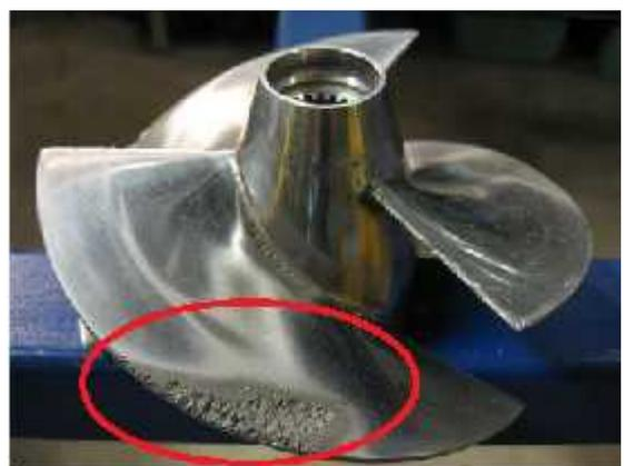
Figura 21 - Puntos críticos de la cavitación en la popa del barco y la hélice
