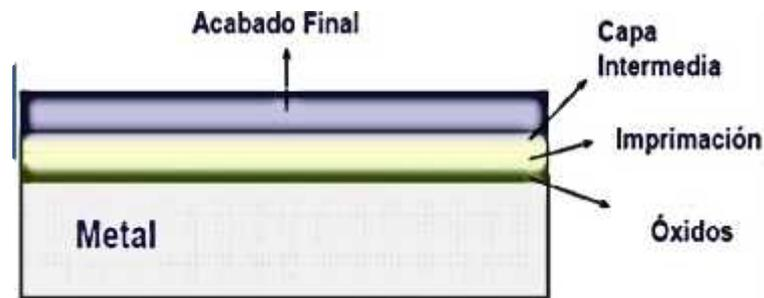
Figura 24 - Esquema representativo de las capas de pintura sobre el casco del buque
