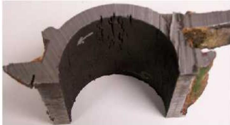
*Figura 17 – Corrosión fatiga con rotura frágil*
