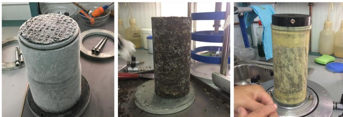
Figura 3.36.- Probeta congelada, desmoldada y con membrana
