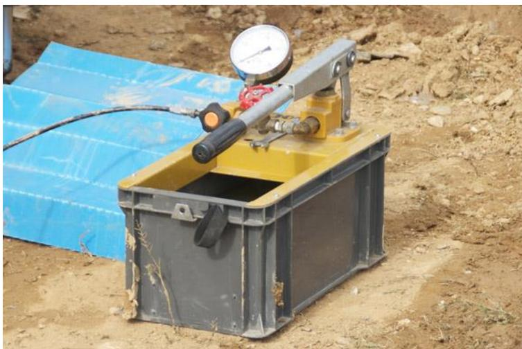
Figura 2.10.- Bomba para ensayo presiométrico
