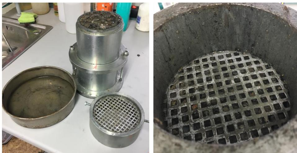
Figura 3.35.- Probeta compactada antes de la congelación
