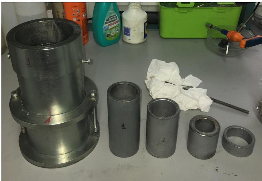
Figura 3.33.- Molde bipartido y espaciadores para la fabricación de probetas triaxiales
