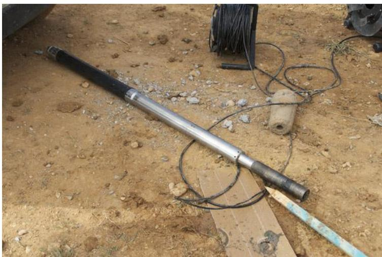
Figura 2.9.- Sonda presiométrica Elastometer-2 HQ 4180
