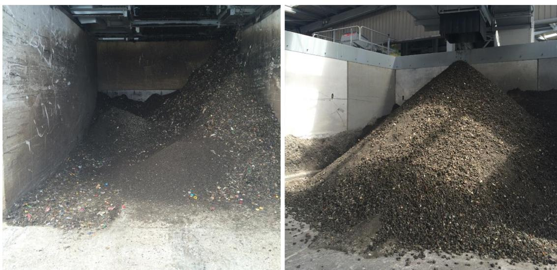
Figura 3.29.- Acopio de rechazo de afino (izquierda) y escorias (derecha) en la planta
