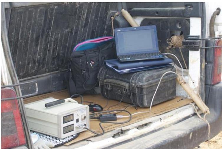
Figura 2.11.- Sistema de adquisición de datos para ensayo presiométrico
