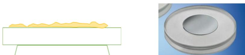
Figura 24: Esquema preparación RTS de la muestra para reducir las orientaciones preferenciales (izda) y portamuestras de silicio de bajo ruido (dcha).
