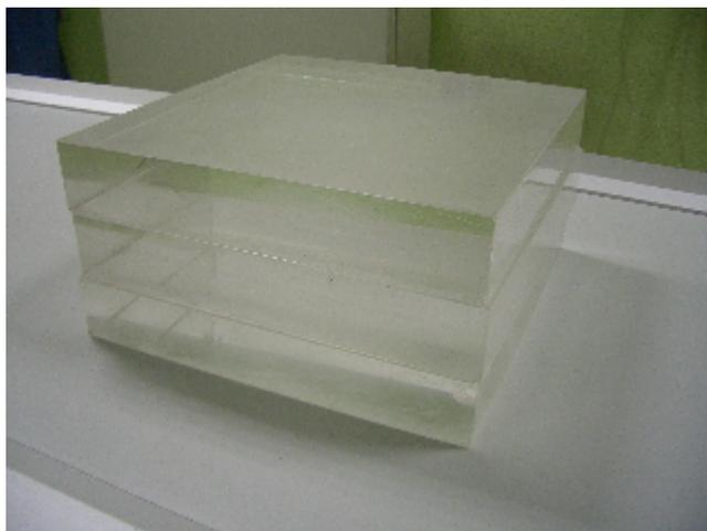
Figura 14: Maniquí de metacrilato utilizado comúnmente en control de calidad en radiodiagnóstico.
