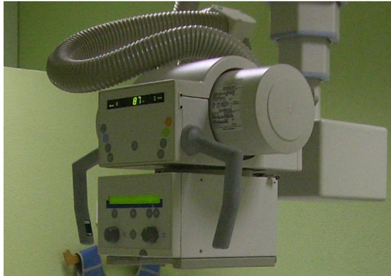
Figura 8: Tubo generador de rayos X sobre un colimador móvil.
