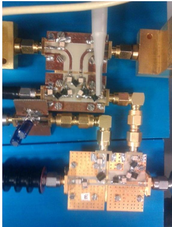
*Figura 6.1. Arquitectura del transistor polar instalado en el laboratorio utilizando en amplificador clase E y el convertidor DC/DC diseñados e implementados en este proyecto*
