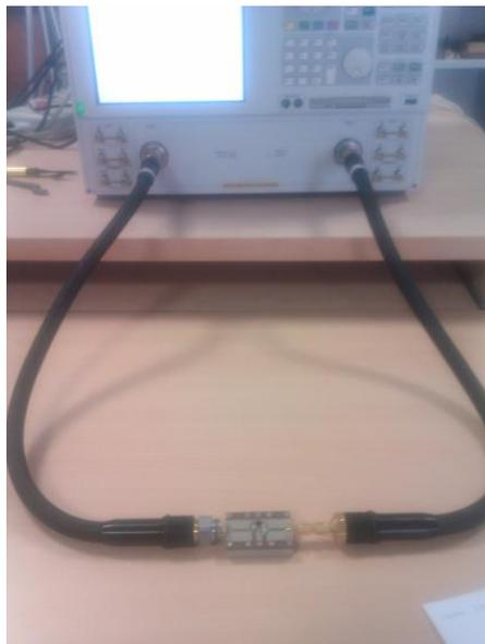
*Figura 4.13. Medida parámetros S de la red de salida con el PNA*
