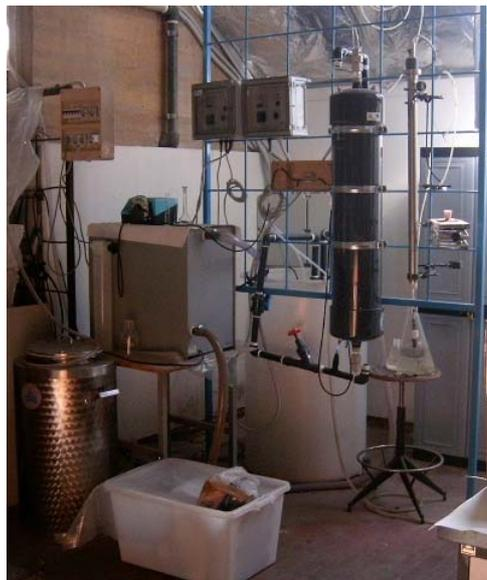
**Figura AIII.2.** Sistema experimental para el tratamiento UV/H<sub>2</sub>O<sub>2</sub> en continuo.
