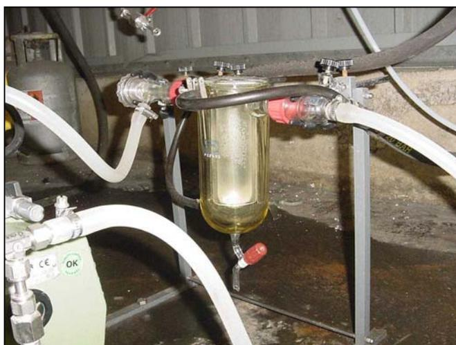
**Figura IV.4. Condensador de vidrio**
