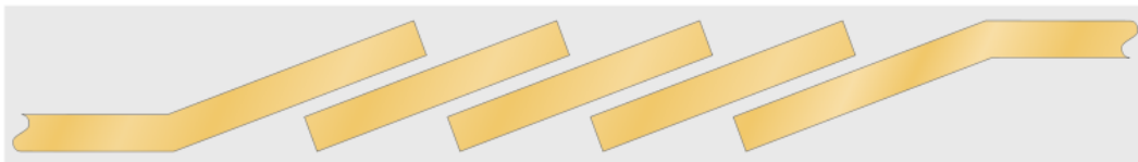
Ilustración 62. Filtro paso banda de líneas acopladas.
