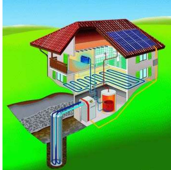
13. "Sistema de captación geotérmico" Fuente: energiaeficaz.es
