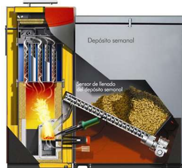
12. "Sección caldera de biomasa" Fuente: climaahorro.es
