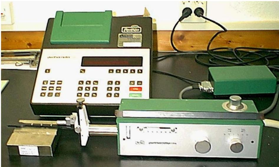
**Figura 5.46.-** *Dispositivo para la determinación de la rugosidad superficial.*
