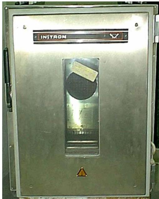
**Figura 5.32.-** Cámara ambiental para ensayos mecánicos.
