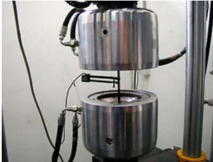
**Figura 3.20.** *Dispositivo del ensayo de tracción.*
