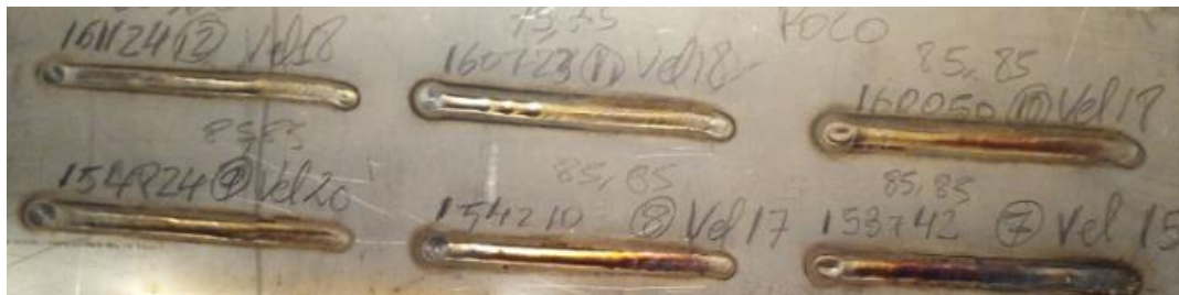
FIGURA 4.6 SOLDADURAS CON POCA INTENSIDAD DE PENETRACIÓN
