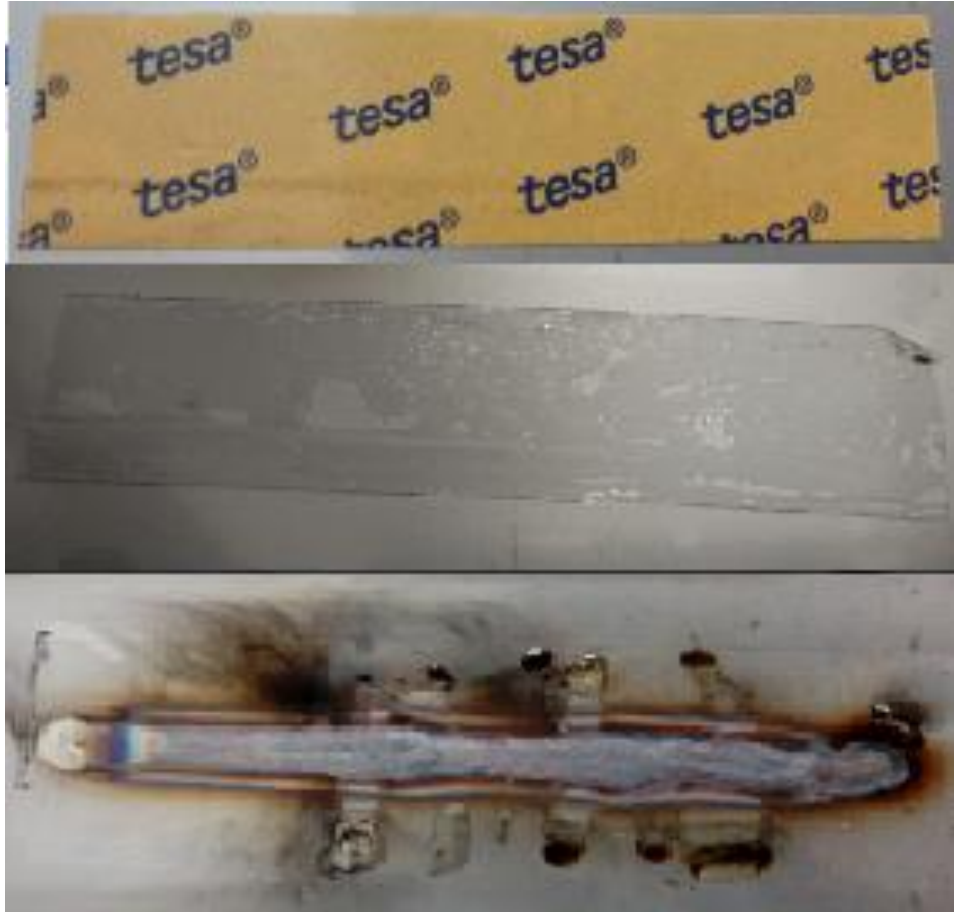
FIGURA 4.8 SOLDADURA CON SIMULACIÓN DE SUCIEDAD
