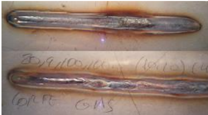
FIGURA 4.9 SOLDADURAS CON CORTES DE GAS
