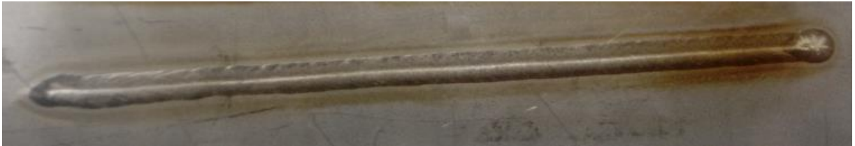
FIGURA 4.16 CORDÓN DE UNA SOLDADURA CORRECTA
