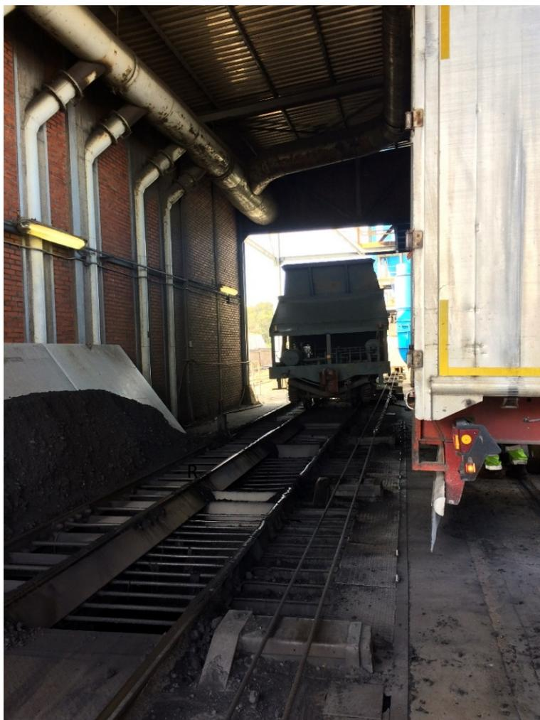
*Ilustración 27: Tolvas de descarga de carbón (fuente: elaboración propia)*
