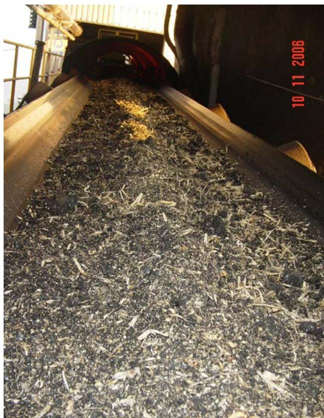
*Ilustración 21: Perspectiva de una cinta que transportaba carbón y serrín mezclado hacia la caldera
