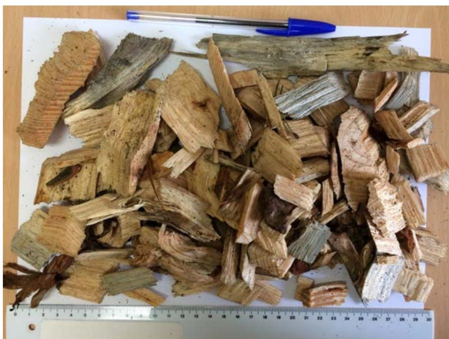
*Ilustración 59: Muestra de astilla 3 (Toranzo) con granulometría excesiva (fuente: elaboración propia)*
