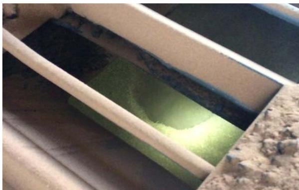
Ilustración 55: Obstrucción de las tolvas de descarga (fuente: elaboración propia)
