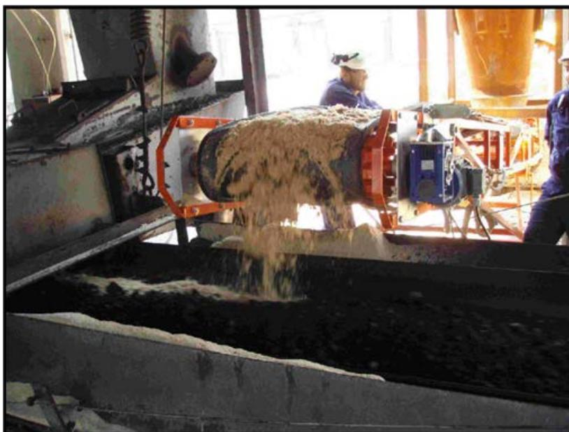
*Ilustración 23: Descarga de la cinta del serrín a la cinta transportadora (Fuente: Solvay)*
