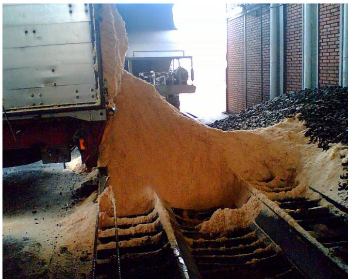
*Ilustración 20: Descarga de serrín en las tolvas de descarga de vagones (fuente: Solvay)*
