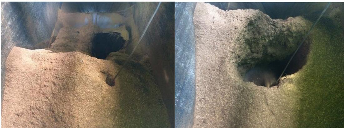
*Ilustración 57: Obstrucción de las tolvas de descarga (fuente: elaboración propia)*
