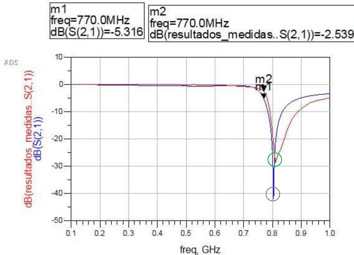
Figura.33 En la figura anterior vemos una simulación electromagnética del dispositivo diseñado previamente (‘m1’) del parámetro S21, y sobre ella además vemos una representación del parámetro S21 de la medida obtenida experimental de un filtro fabricado de iguales características (‘m2’).
