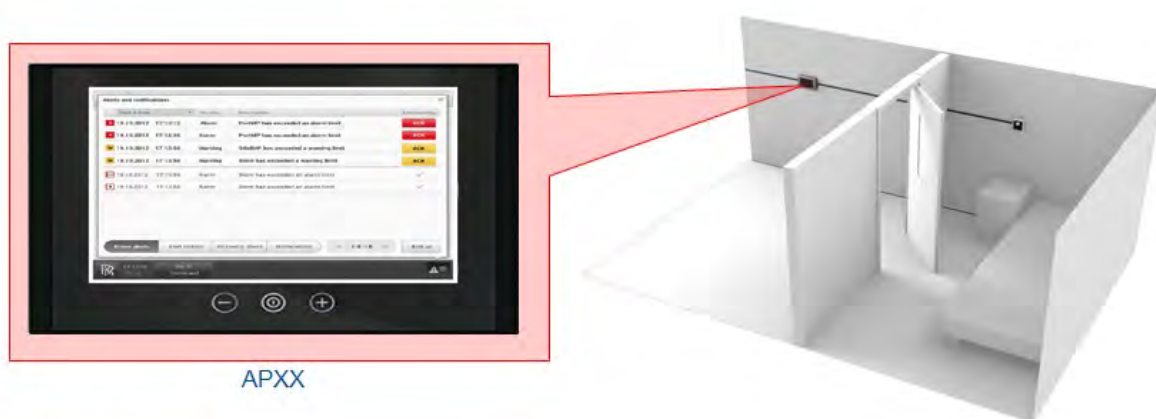
Ilustración 7.13 – Panel de extensión de alarmas
