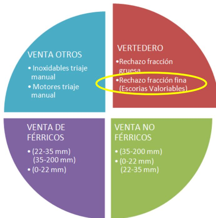
Figura 10. Destino de flujos de salida de la Planta de Valorización de Escorias.
