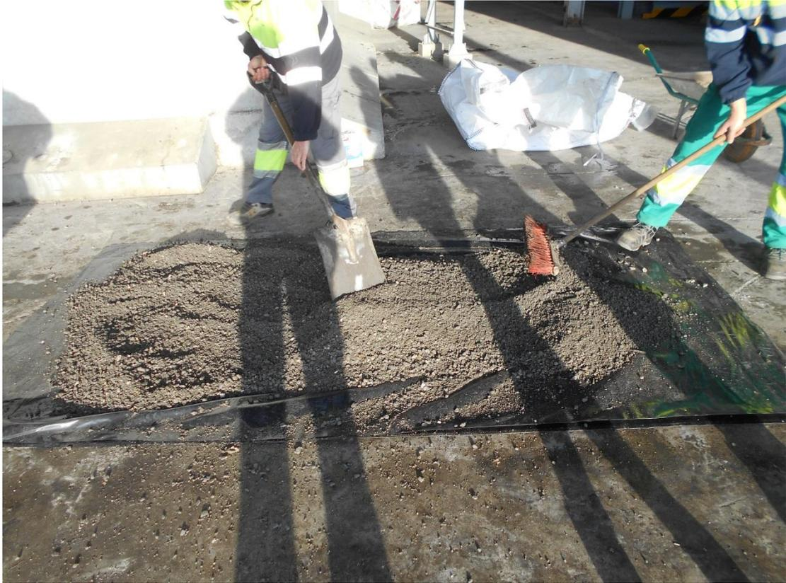
Figura 2. Distribución de la muestra cribada sobre la superficie.
