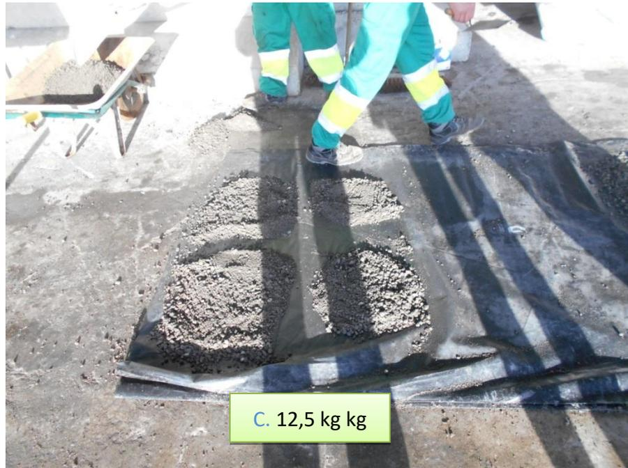
Figura 10. Cuarteo de la nueva muestra C, obtenida a partir de A.
