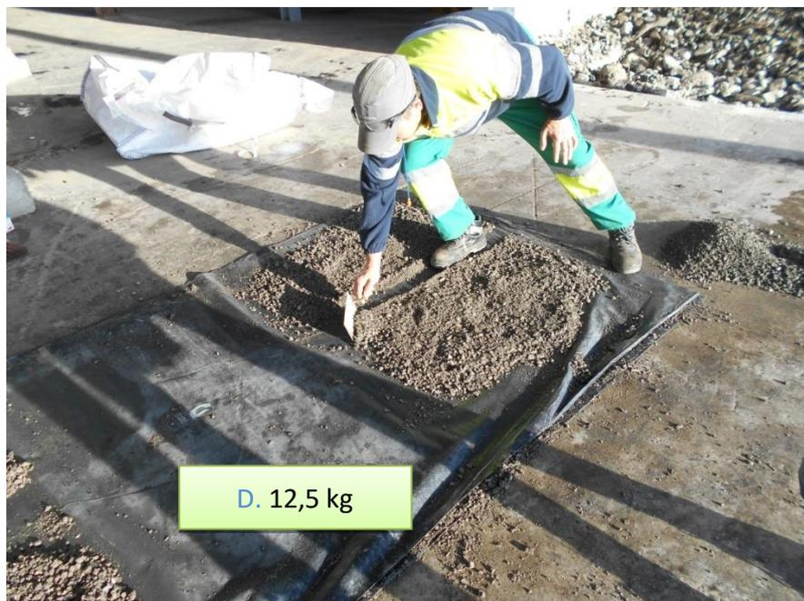
Figura 13. Cuarteo de la nueva muestra D, obtenida a partir de dos cuartos opuestos de B.
