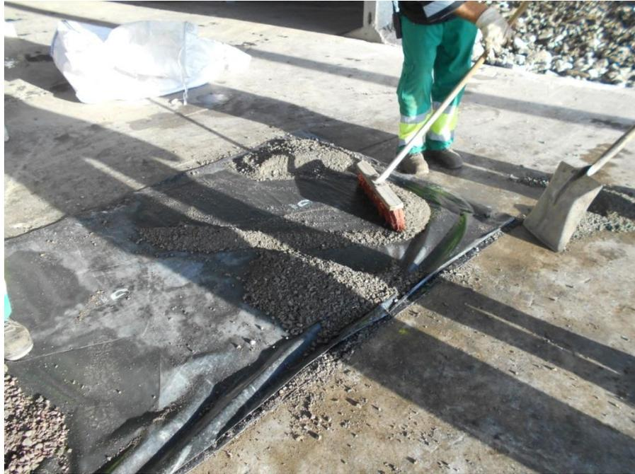
Figura 12. Eliminación de dos cuartos opuestos de B.
