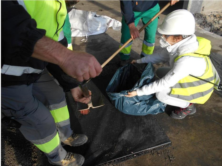
Figura 14. Dos cuartos opuestos de muestra D se guardan en bolsa. Muestra 2.
