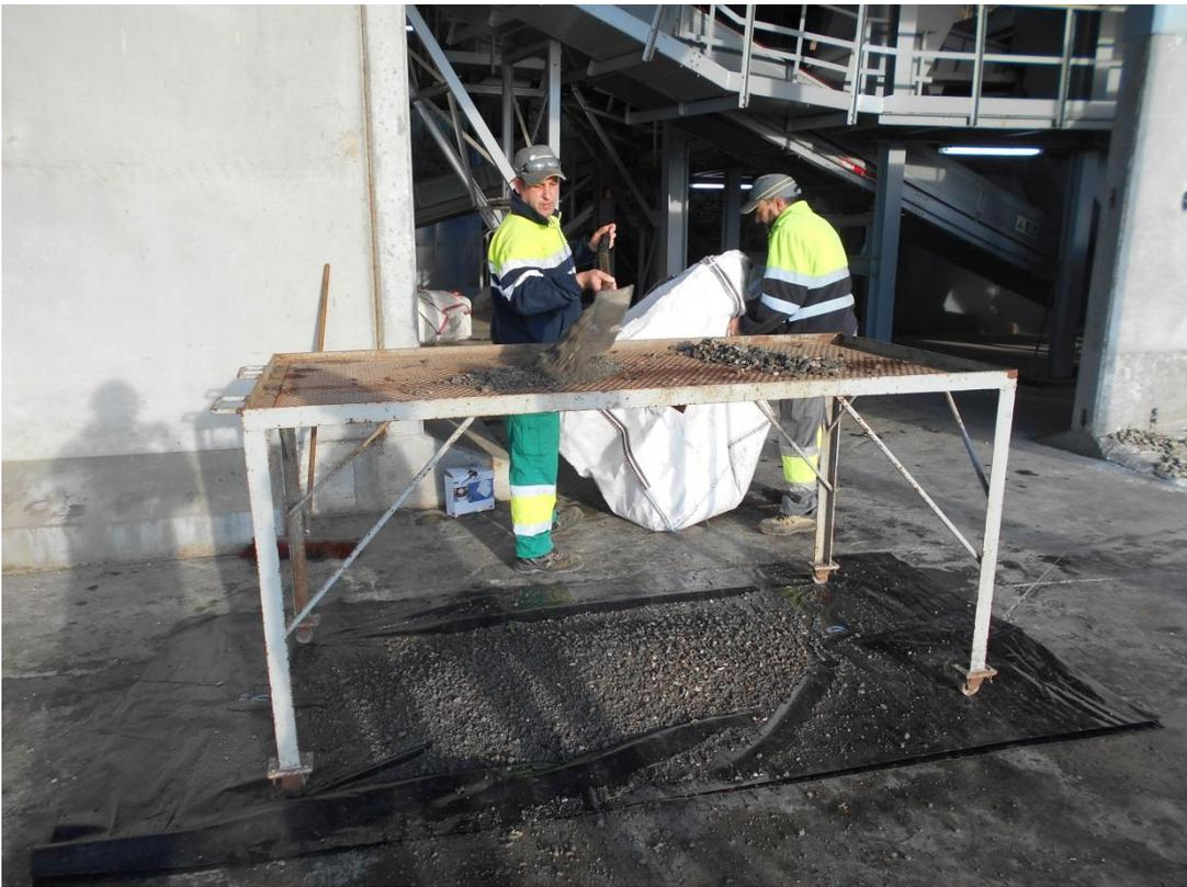
Figura 1. Muestra bruta pasando por la mesa de cribado 14 mm.
