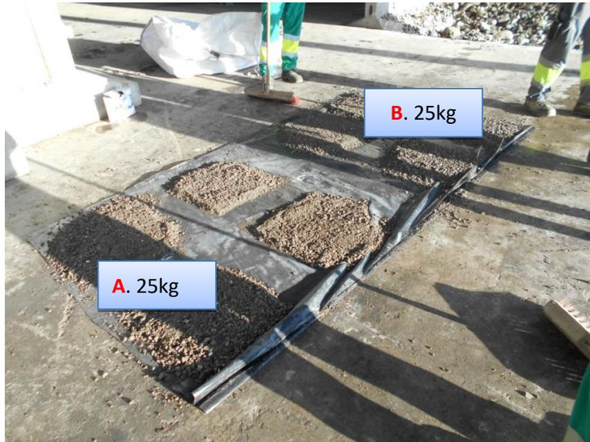
Figura 8. Resultado del tercer cuarteo, A y B cuarteados.
