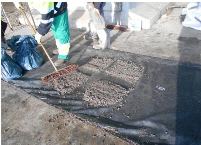
Figura 12. Cuarteo y recogida de muestra de laboratorio.
