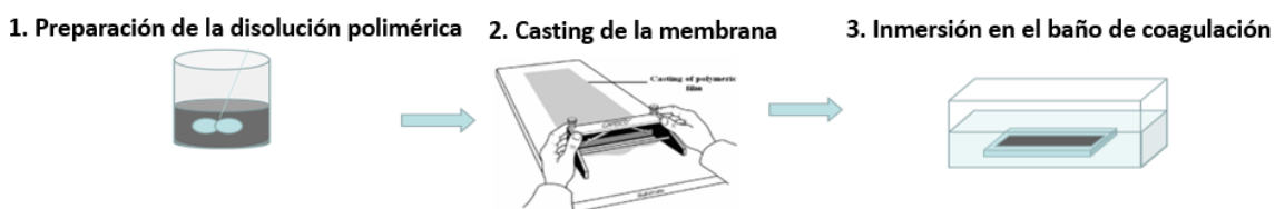
Figura 3. Esquema de preparación de membranas por la técnica de inversión de fases
