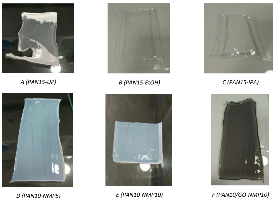
Figura 9. Imágenes de las membranas fabricadas con diferentes concentraciones de polímero y baños de coagulación
