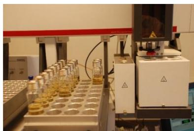
Figura 2.31. Rack de muestras y agitador magnético para la extracción SPME.
