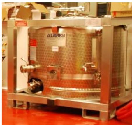
Figura 2.14. Tanque de acero inoxidable para las fases alimentación y/o extractante.
