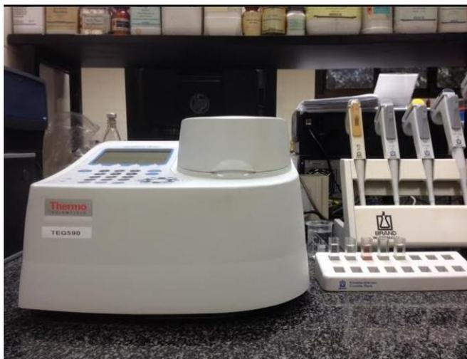
Figura 2.42. Espectrofotómetro UV/VIS utilizado para la determinación del índice de polifenoles totales e intensidad colorante de los vinos.
