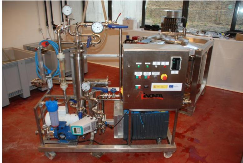
Figura 2.11. Fotografía del equipo de desalcoholización parcial de vino.
