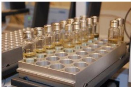
Figura 2.38. Rack dónde se introducen los viales para su análisis en el cromatógrafo.
