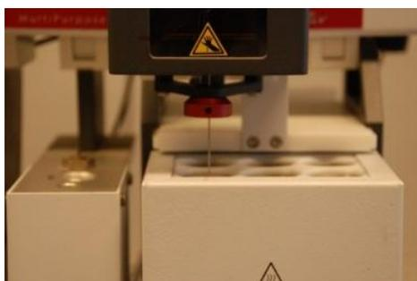
Figura 2.30. Agitador magnético para la extracción SPME.
