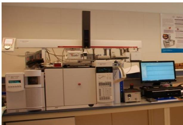
Figura 2.28. Cromatógrafo de gases GC 7890A.
