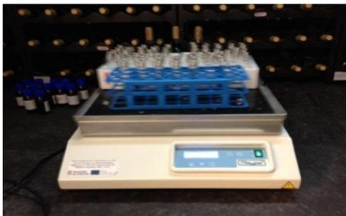
Figura 2.37. Agitación de los viales en cámara frigorífica a temperatura controlada.
