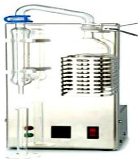
Figura 2.41. Destilador empleado en la determinación de la acidez volátil según el Método García – Tena.
