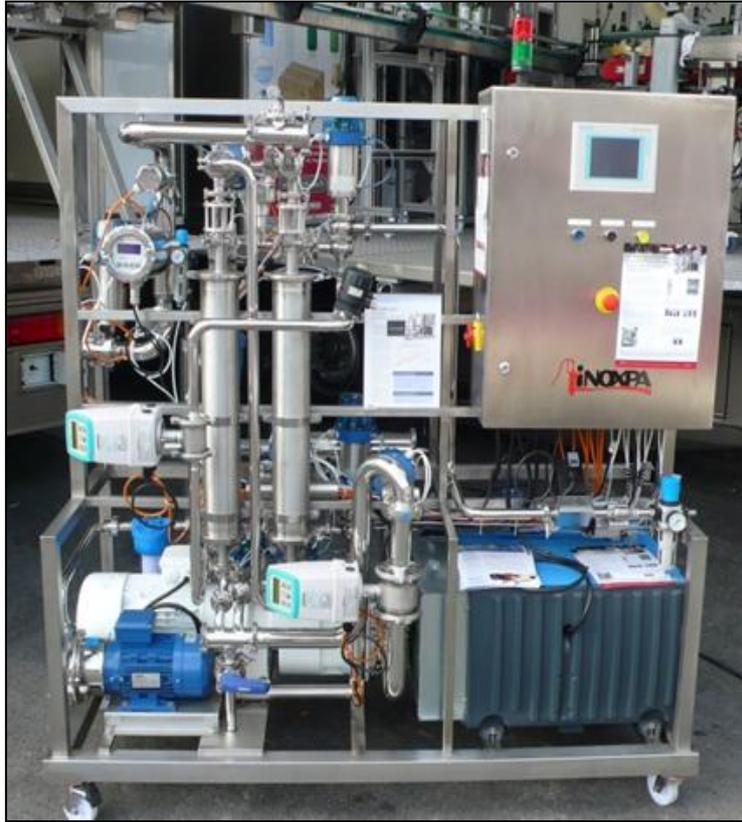
Figura 1.19. Equipo de pertracción evaporativa de la empresa INOXPA.
