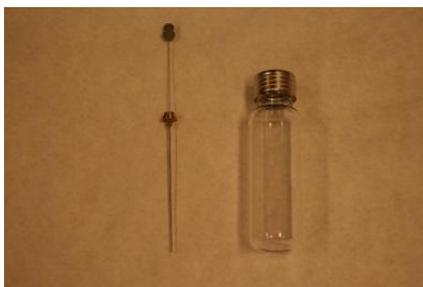
Figura 2.29. Fibra de PDMS y vial de 20mL.
