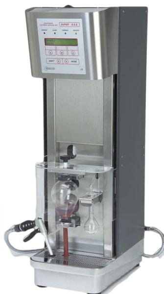
Figura 2.24. Destilador de grado alcohólico (Gibertini®).
