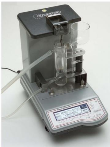
Figura 2.25. Balanza hidrostática (Gibertini®).
