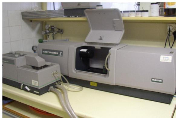
**Figura 4.10.** Equipo de difracción láser (Mastersizer X, Malvern Instruments, Inc.)
