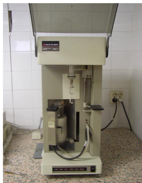
**Figura 4.7.** Equipo para el análisis termogravimétrico. (Perkin Elmer TGA 7).
