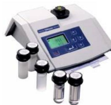
**Figura 4.6.** Turbidímetro, Turbiquant® 3000.
