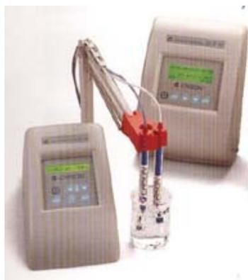
**Figura 4.4.** Electrodo Selectivo de Fluoruros.
