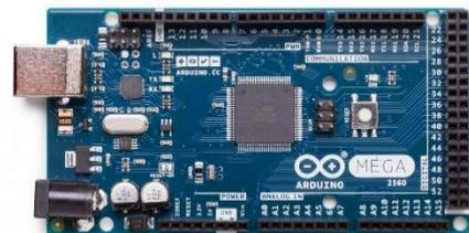
**Figura 2.4:** Placa Arduino Mega
