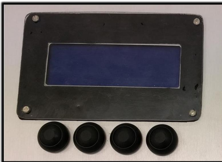
**Figura 7.11: Módulo LCD montado.**
