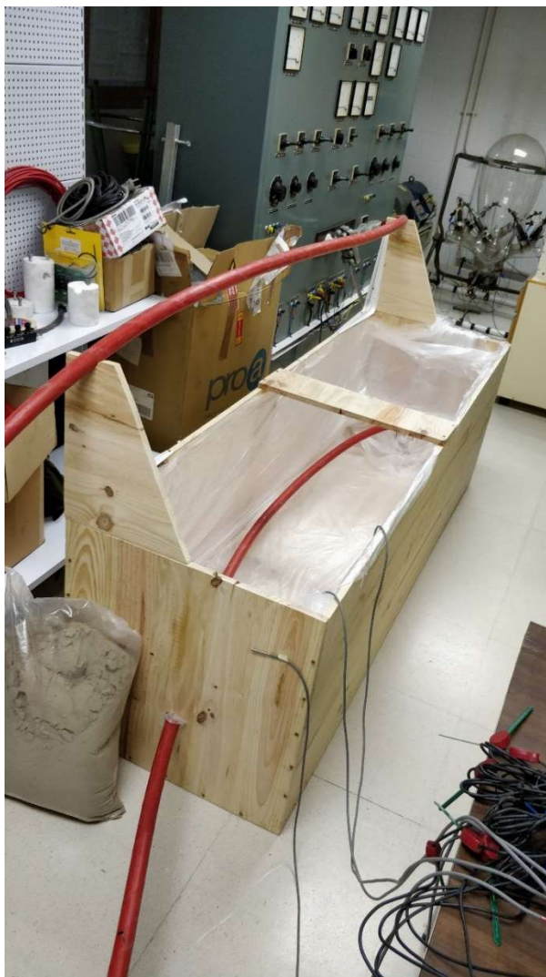
Fig. 43. Disposición final del cable sobre los apoyos.
