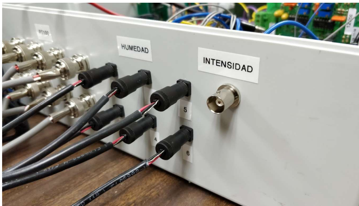
Fig. 6. Conexiones de las sondas en la caja del sistema de medición.
