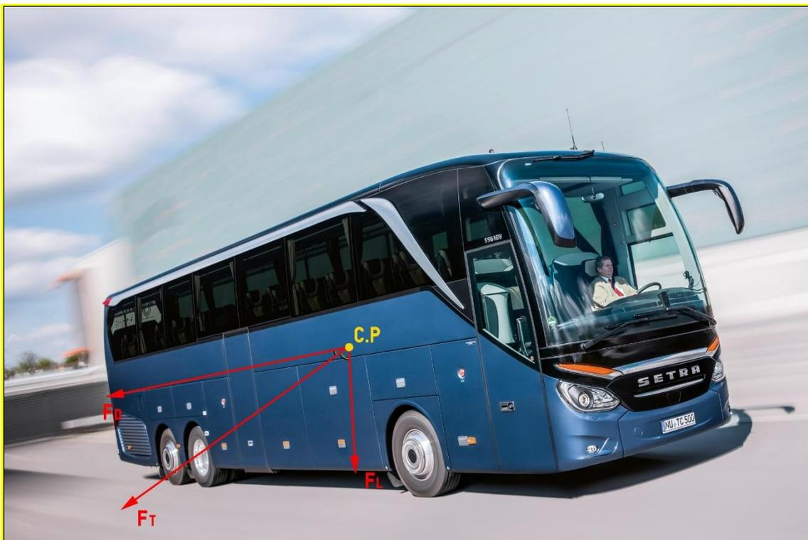
Figura 19. Esquema con el centro de presiones del autobús. (Setra reisibus, 2014)
