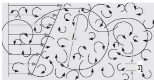
Figura 14. Turbulencias que resuelve la técnica DNS. (Çengel, 2012)
