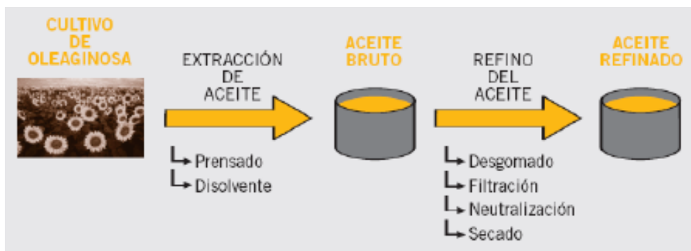
Figura 19. Esquema proceso de refinado de aceite. Fuente [42]
