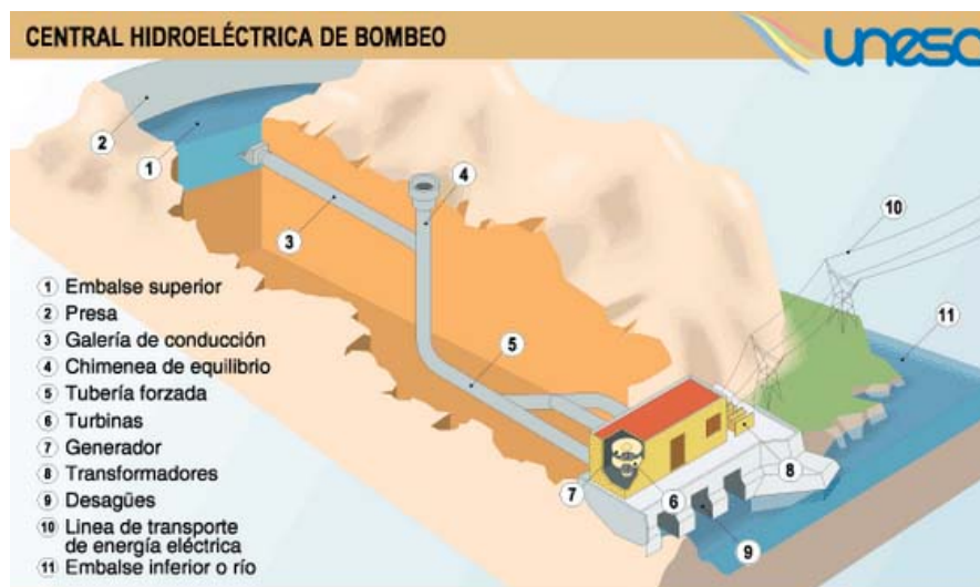
Figura 25: Esquema central hidroeléctrica de bombeo [31]
