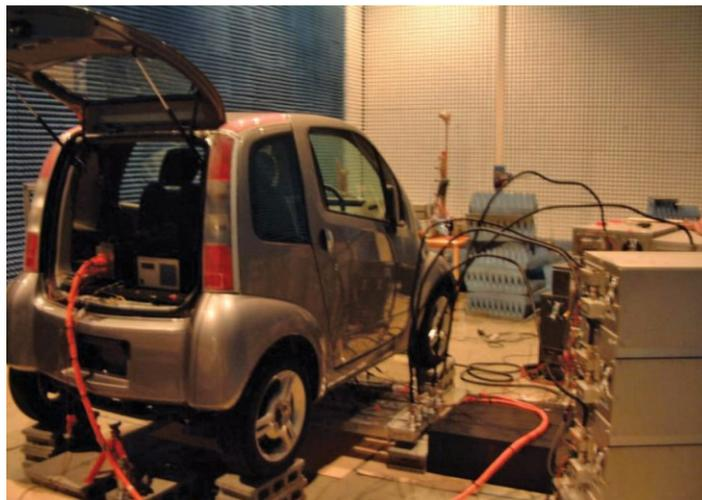
*Figura 2.14 Experimentos de recarga inalámbrica con microondas realizados en la Universidad de Kioto [18].*
