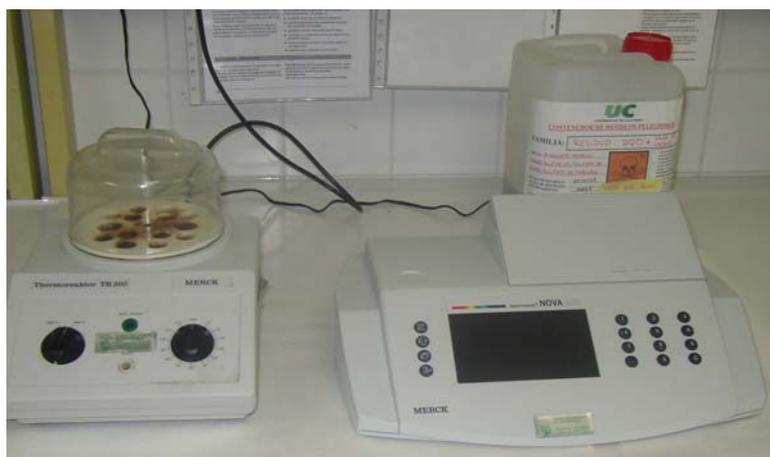
Figura 3.15. Termorreactor y fotómetro para determinación del valor de la DQO de los permeados obtenidos en los ensayos de pervaporación de agua/acetona.
