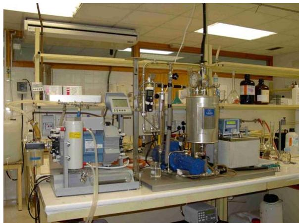
Figura 3.6. Instalación experimental de pervaporación.
