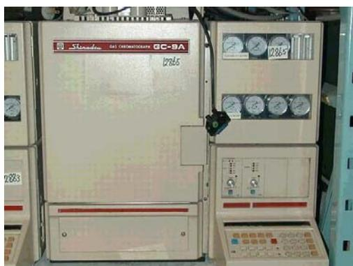
**Figura 3.17. Cromatógrafo de gases Shimadzu GC-9A.**
