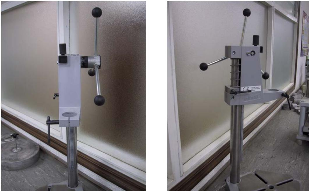
**Figura 3.4. Soporte para taladro adquirido para el sistema de excavación de la columna de grava**
