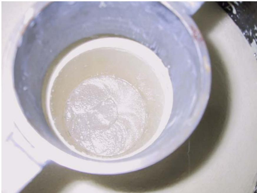
**Figura 3.6. Fondo de la excavación con la capa de arena colocada**
