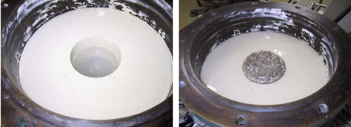
**Figura 3.7. Orificio antes de la colocación de la columna con la chapa de separación, y después, una vez colocada la columna de grava**
