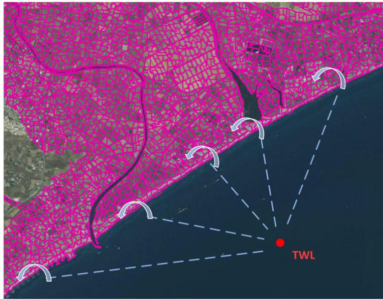
Figura 3.20: Representación conceptual del TWL inundando el mallado del modelo RFSM-EDA
