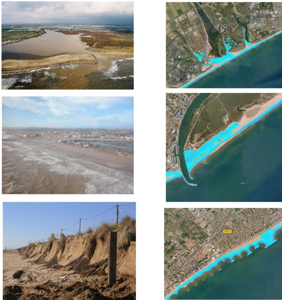
Figura 3.21: Casos reales (izquierda) y simulaciones con el RFSM-EDA (derecha)
