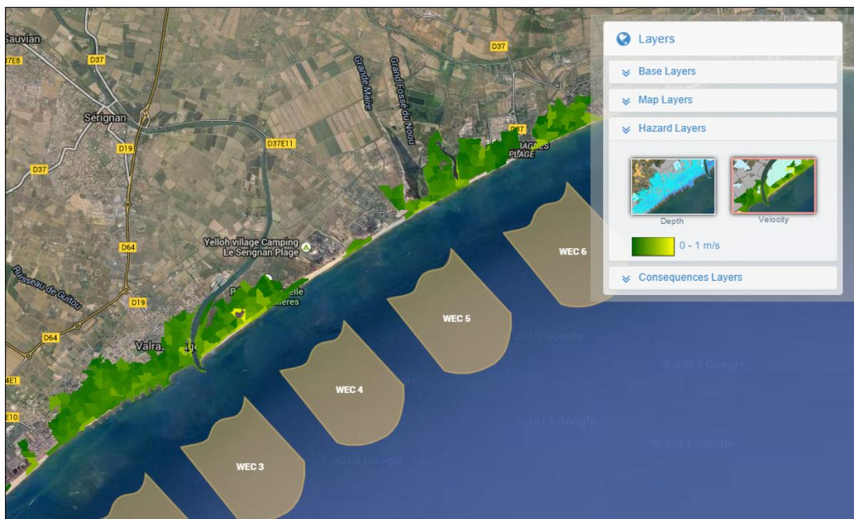
Figura 3.23: IH-DSS Flooding - resultados del modelo de inundación (velocidades)
