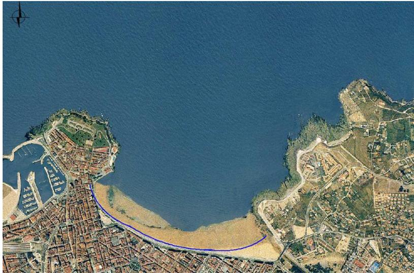
Figura 12.- Forma en planta de equilibrio con la arena de aportación en la Playa de San Lorenzo una vez efectuadas las obras de ampliación
