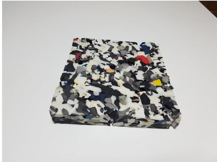
**Ilustración 4-16 Muestra de base amortiguadora formada por diferentes corchos reciclados
