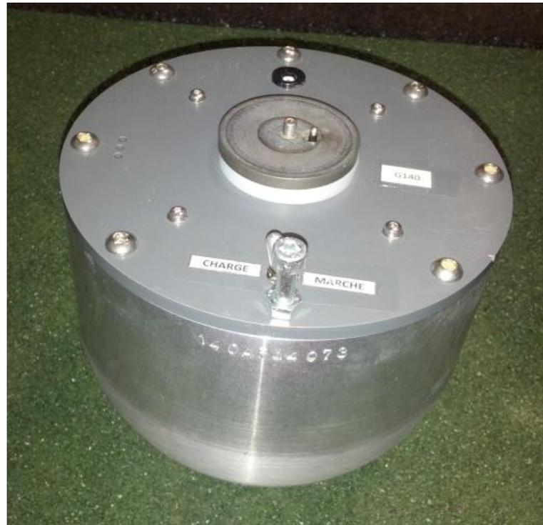
**Ilustración 5-1 Cabeza maniquí con acelerómetro triaxial (Fuente: Sanpe Ingeniería)**
