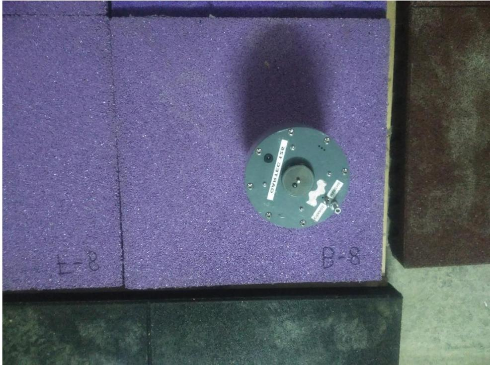
Ilustración 11-10 Disposición de ensayo de determinación de altura de caída crítica en Fase 2. Muestra B-8 (Fuente: elaboración propia)
