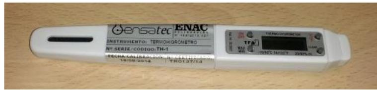
Ilustración 5-4 Termo-higrómetro (Fuente: Sanpe Ingeniería)
