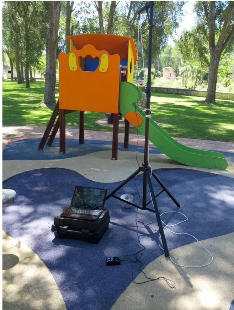
**Ilustración 5-3 Realización de un ensayo de determinación de la altura de caída crítica "in situ" con un trípode (Fuente: Ingeniería Sanpe)**
