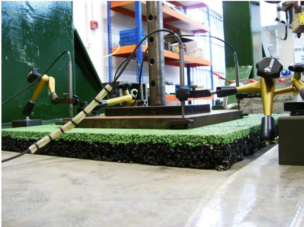
Ilustración 11-2 Detalle disposición de ensayo de rigidez en Fase 1 (Fuente: LADICIM)
