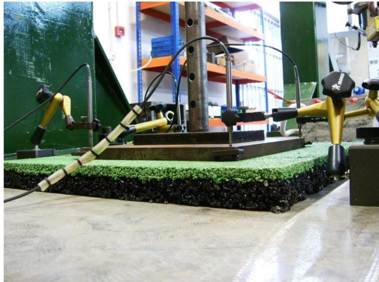
Ilustración 5-5 Disposición del ensayo de rigidez (Fuente: LADICIM)
