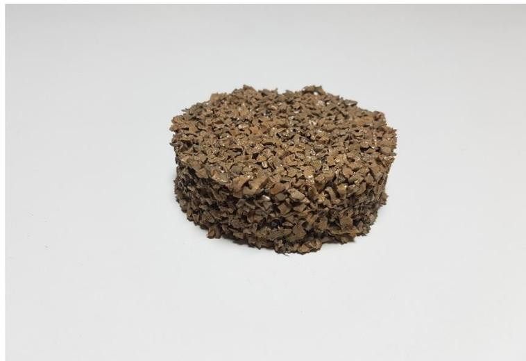
**Ilustración 4-18 Muestra de capa de 10 mm de espesor de EPDM vulcanizado en color marrón mezclados con resina (Fuente: Sanpe Ingeniería)**
