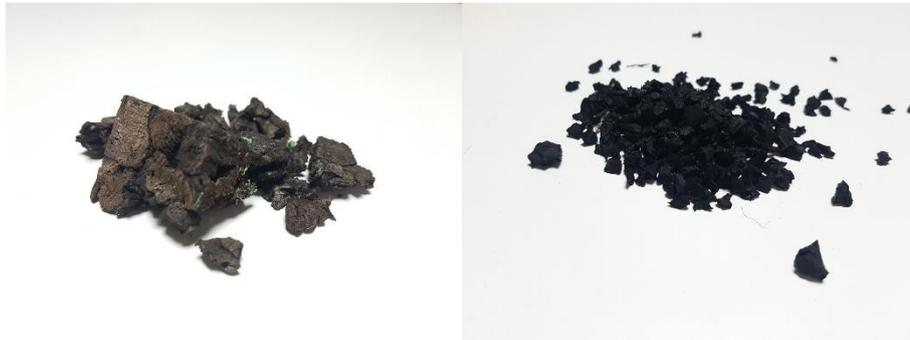
**Ilustración 4-17 Muestra de dos granulometrías diferentes de caucho SBR reciclado (Fuente: Sanpe Ingeniería)**
