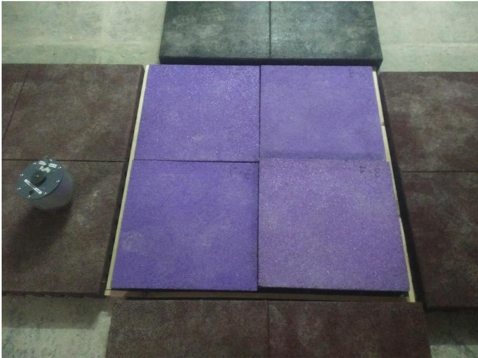
**Ilustración 11-8 Colocación de las probetas sobre marco en Fase 2 (Fuente: elaboración propia)**
