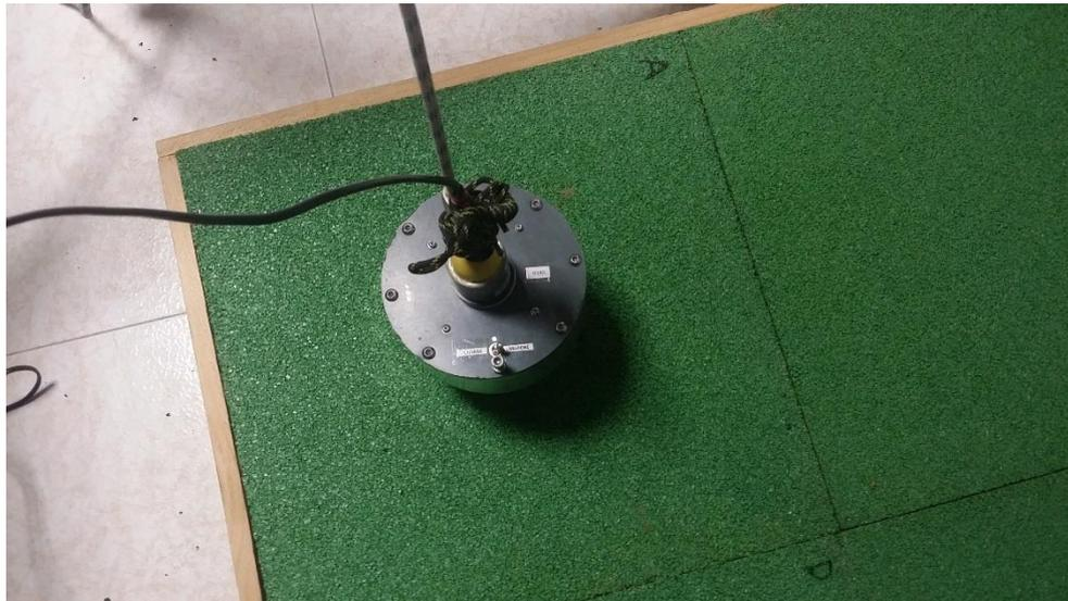
**Ilustración 11-5 Disposición de ensayo de altura de caída crítica en Fase 1. Muestra A (Fuente: elaboración propia)**
