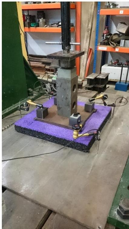
**Ilustración 11-7** Disposición de ensayo de rigidez estática en Fase 2. Muestra B-6. (Fuente: LADICIM)
