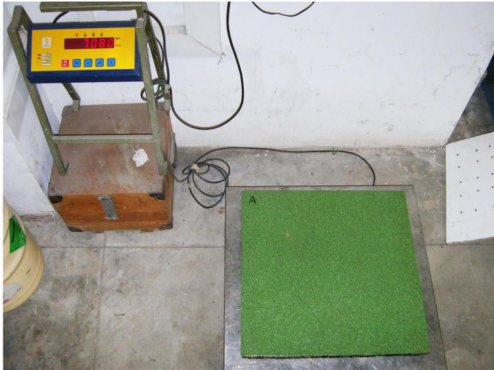
**Ilustración 11-4 Pesaje de muestras en Fase 1. Muestra A (Fuente: LADICIM)**
