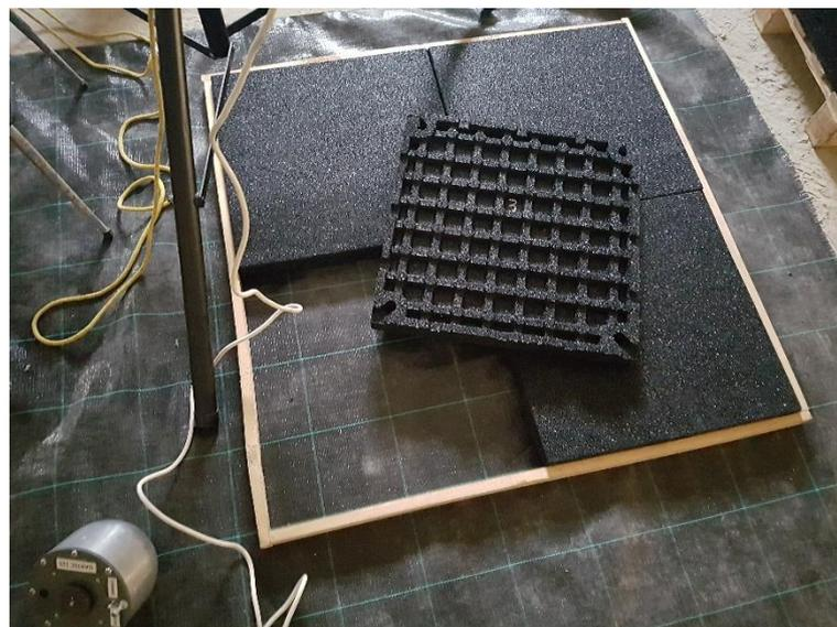
**Ilustración 7-1** Ensayo determinación de la altura de caída de caída crítica de losetas de caucho prefabricadas. (Fuente: Sanpe Ingeniería)
