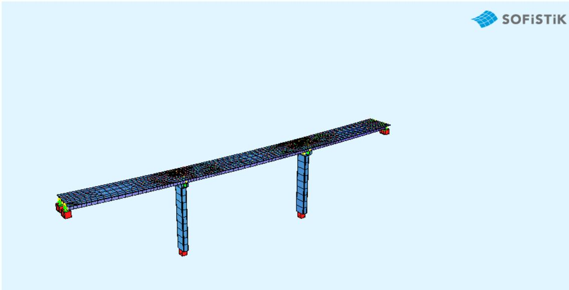
En segundo lugar, observando las deformadas de cada una de las soluciones se puede distinguir que las flechas producidas en el caso de la estructura isostática conformada por las vigas prefabricadas de hormigón son mucho mayores que en el caso de las vigas prefabricadas mixtas, esto es debido al sistema de viga continua, que al trabajar conjuntamente suaviza las deformaciones que sufre la estructura.
