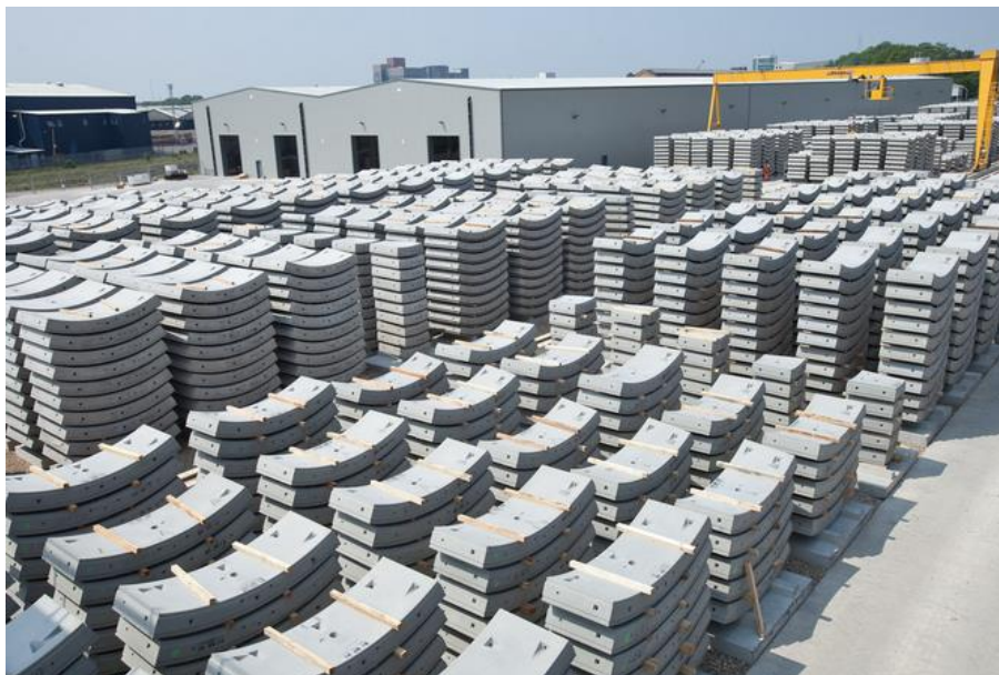
Ilustración 15. Dovelas utilizadas en los túneles del Crossrail. Fuente: Crossrail. http://www.crossrail.co.uk/
