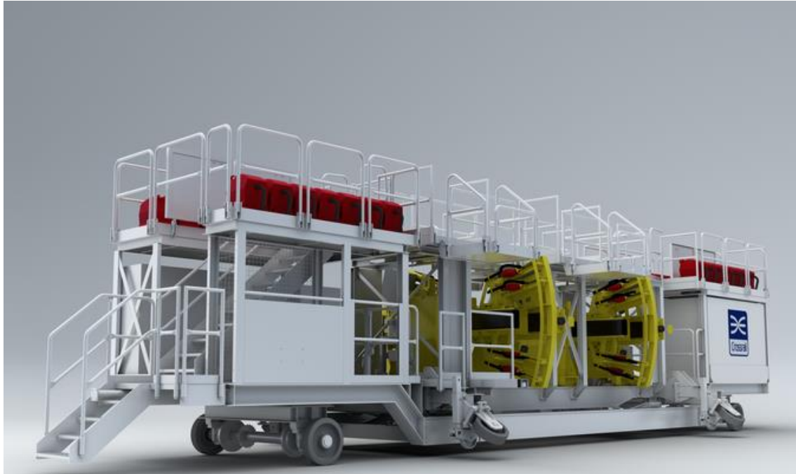
Ilustración 20. Plataforma de perforación para líneas eléctricas. Fuente: Crossrail. http://www.crossrail.co.uk/
