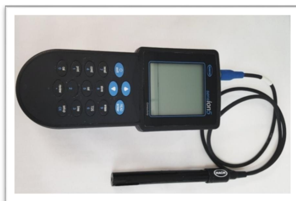
Figura 2.6. Conductímetro sensION 5 de la casa comercial HACH empleado en el TFG.
