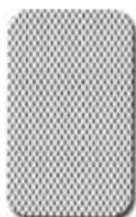
Figura 2.2. Malla espaciadora de polipropileno
