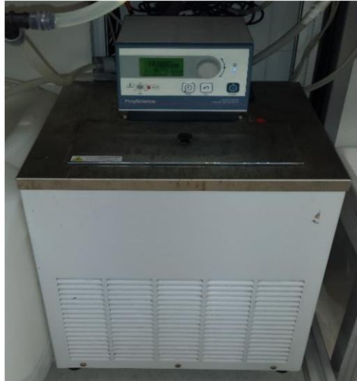
*Figura 10. Baño termostático utilizado.*
