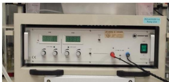
*Figura 11. Fuente de potencia de la instalación comercial EDBM.*
