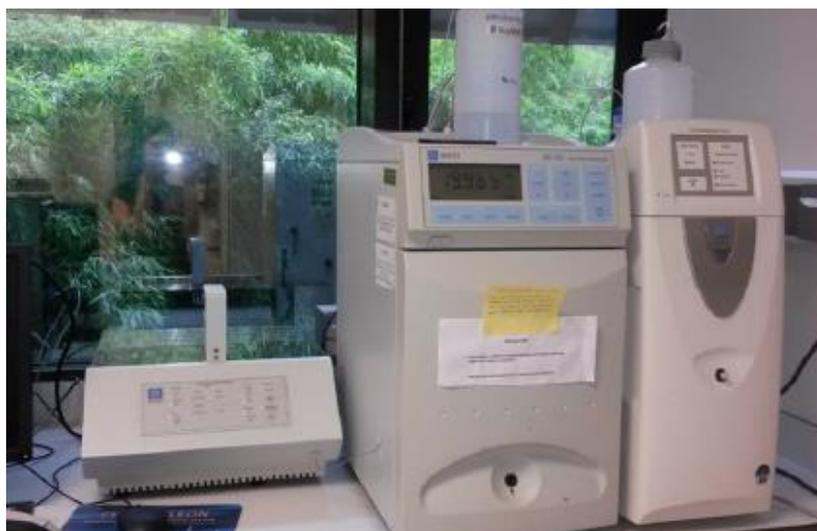
*Figura 15. Equipos de cromatografía DX-120, ICS-1100 y automuestreador AS40.*
