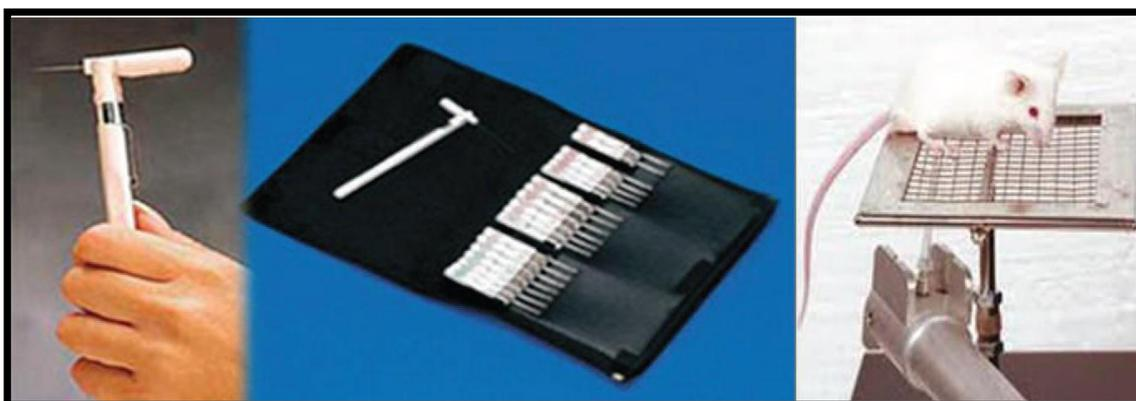
**Figura 10. Prueba de von Frey. Monofilamentos de von Frey y aparato.** La imagen (A) presenta el grupo de monofilamentos de von Frey para evocar estímulos mecánicos en la superficie plantar de la pata trasera de los ratones. La imagen (B) muestra la posición que debe tener el pelo de von Frey para acceder a las patas traseras del animal en el suelo de rejilla desde la parte inferior de ésta.
