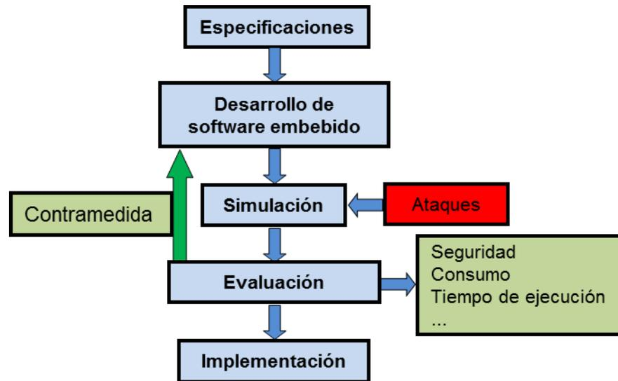
Figura 48: Diseño de firmware seguro.
