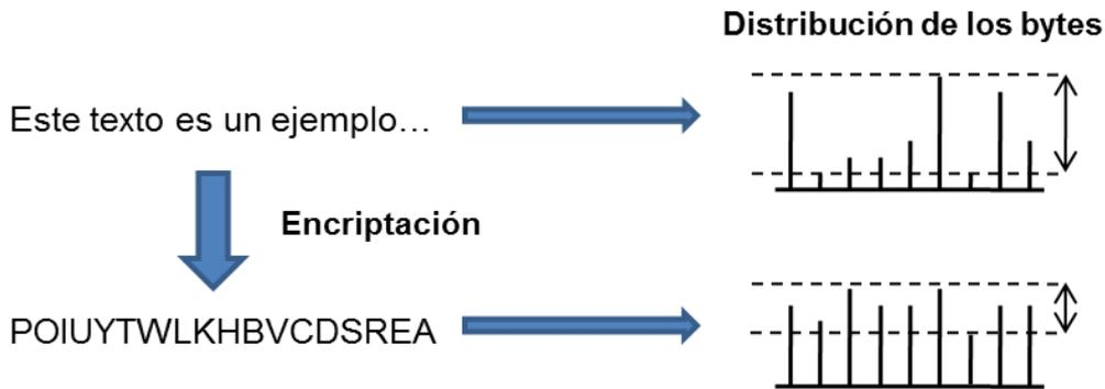
**Figura 55: Distribución de caracteres de un mensaje plano y encriptado**
