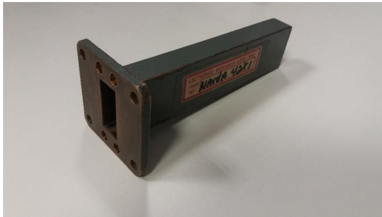
Figura 31. Carga adaptada de Narda.
