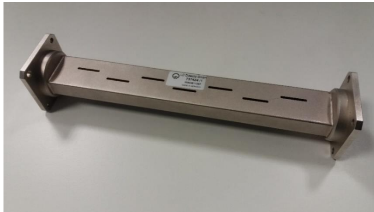
Figura 37. Antena ranurada en guía de onda con 7 ranuras, cuya longitud de ranura es de 20 mm.
