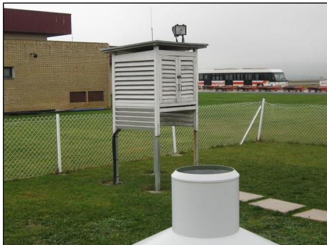
Figura 1.1: Garita Meteorológica en el aeropuerto de Noaín (Pamplona / Navarra)
