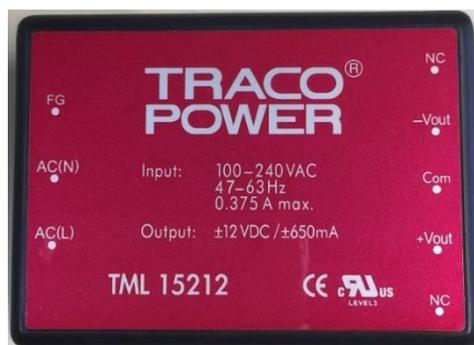
Figura 4.18. Transformador Traco® Power con salida  $\pm 12$ V. Fuente: Elaboración propia.
