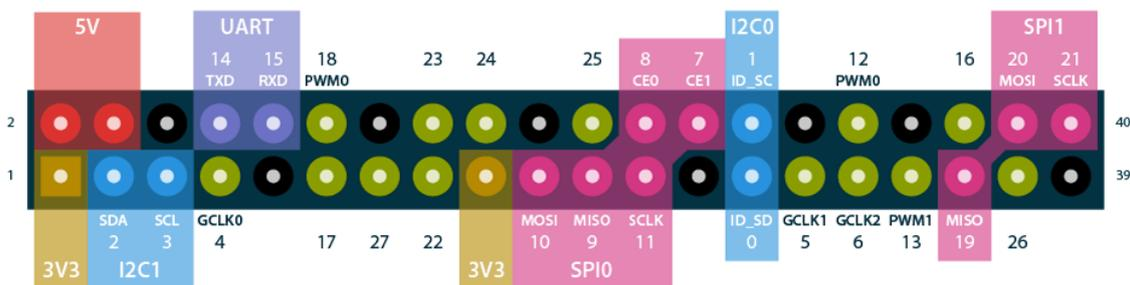
Figura 4.5. Diagrama de asignación de pines de los protocolos de comunicación. Fuente: pinout.xyz.
