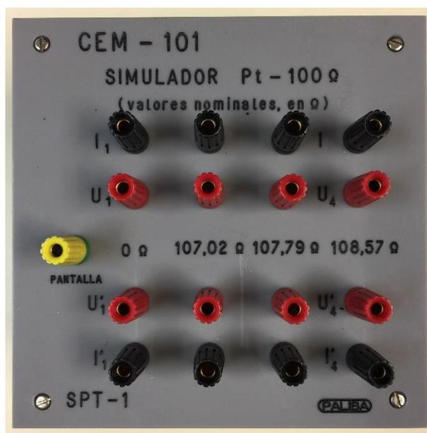
Figura 4.34. Simulador de resistencias de platino calibrado por el Centro Español de Metrología. Fuente: Elaboración propia.
