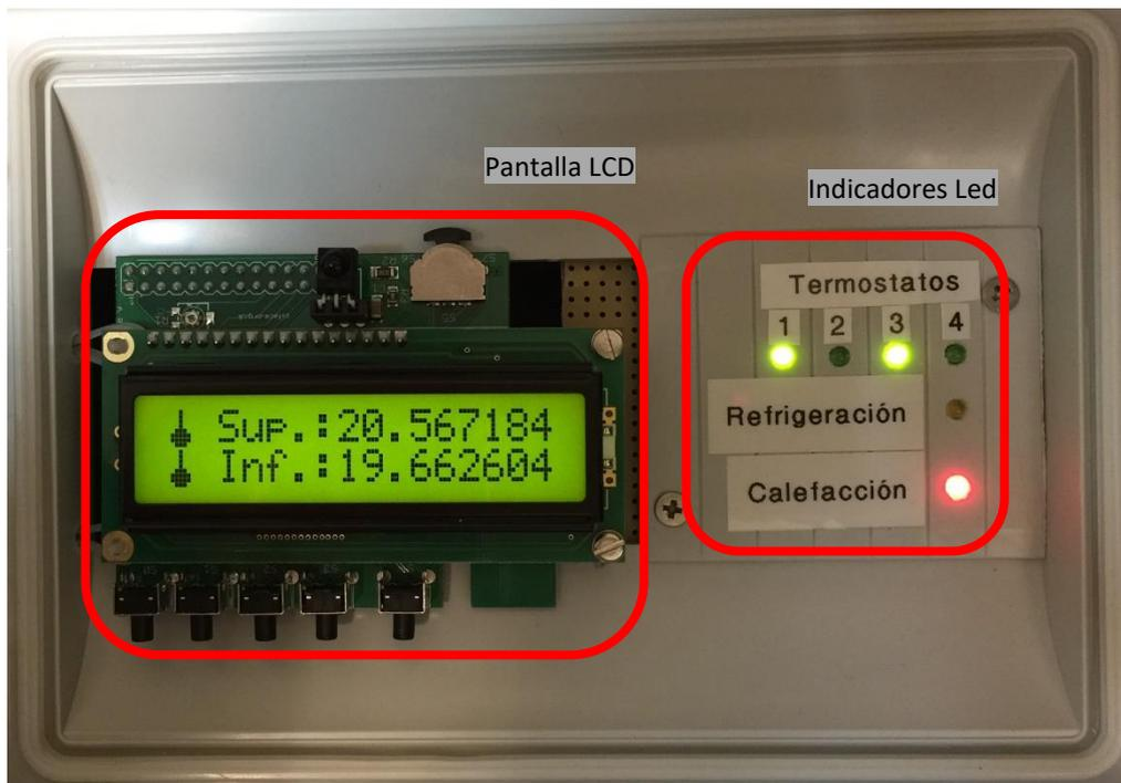
Figura 4.28. Componentes instalados en la ventana de la caja. Fuente: Elaboración propia.
