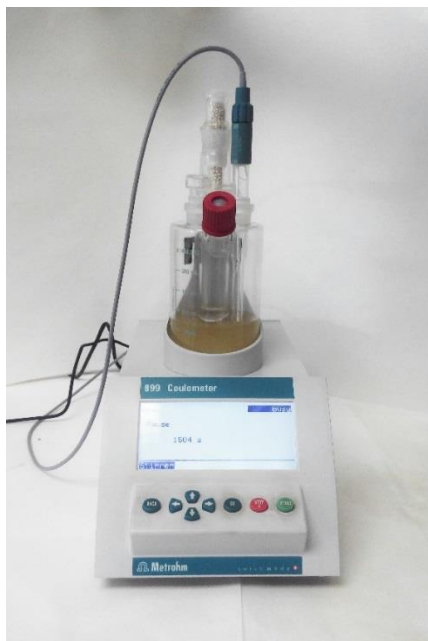
Figura 3.1. Instrumento de medida de humedad Karl Fisher utilizado para el presente trabajo fin de grado.
