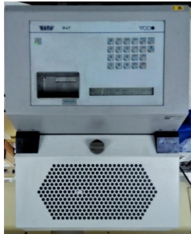
Figura 3.6. Ensayador dieléctrico utilizado para medir el \tan \delta de la muestra de aceite.
