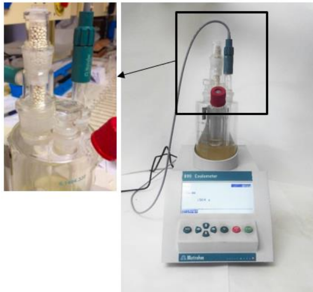
Figura 4.9. Detalle del tubo de adsorción con tamiz molecular.
