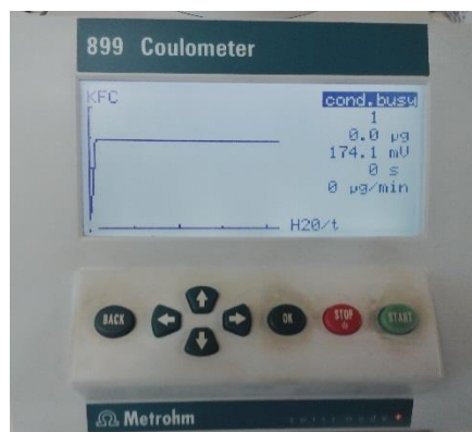
Figura 4.11 . Gráfica solución de la cantidad de agua de la muestra.
