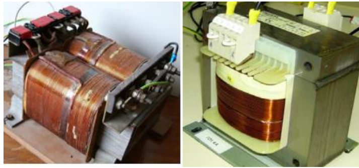
Figura 2.11. Tipos de Transformadores Monofásicos: De columnas y acorazado (Fuente: [15]).
