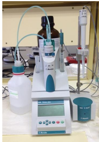
Figura 3.4. Titulador potenciométrico Metrohm 848 Tritino plus utilizado para medir la acidez de la muestra en el presente trabajo de fin de grado.
