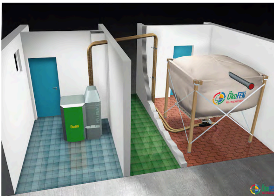
Ilustración 2: Imagen general de una instalación de biomasa en un edificio. Fuente: Solargal.
