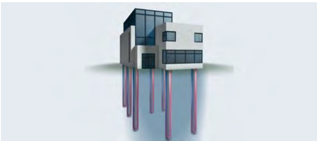
Ilustración 25: Instalación de pilones geotérmicos. Fuente uponor.
