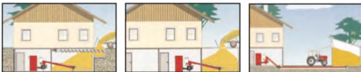
Ilustración 9: Sistemas de almacenamiento dentro del edificio, fuera del edificio y cercano al edificio. Fuente: IDAE
