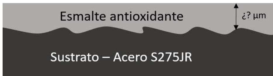
Figura 86. Detalle sistema pintura - Maqueta 1
