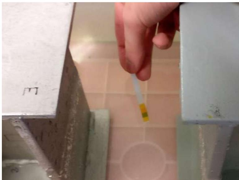
Figura 91. Medición del pH del agua
