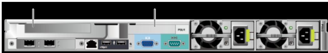
Figura 12 – Panel posterior del Huawei RH1288 v3 [20]
