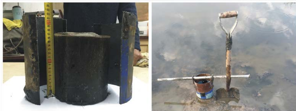
Figura RP.20. Fotografías mostrando el espesor de sedimento acumulado en el Arroyo San Vicente entre 2003 y 2015.
